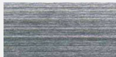
Brusný lamelový kotouč se zrnem 40 Dlouhé průběžné čáry, Minimální prohloubení, Hladký koncový brus
